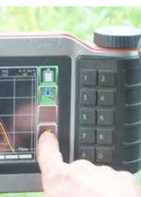
Modulation dans le boîtier de commande en fonction de la vitesse et position GPS
