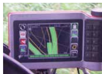
l'agriculteur programme la dose à épandre, l'écran affiche la quantité cumulée épandue, la surface épandue et la surface restante) et l'interface GPS (à droite : les zones épandues sont colorées en vert)
