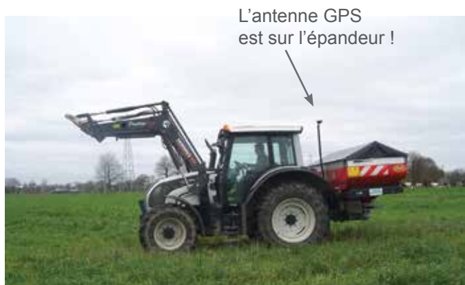
L'antenne GPS est installée sur l'épandeur. Ainsi, les adhérents peuvent utiliser leur propre tracteur tout en bénéficiant de la coupure automatique de tronçons.
